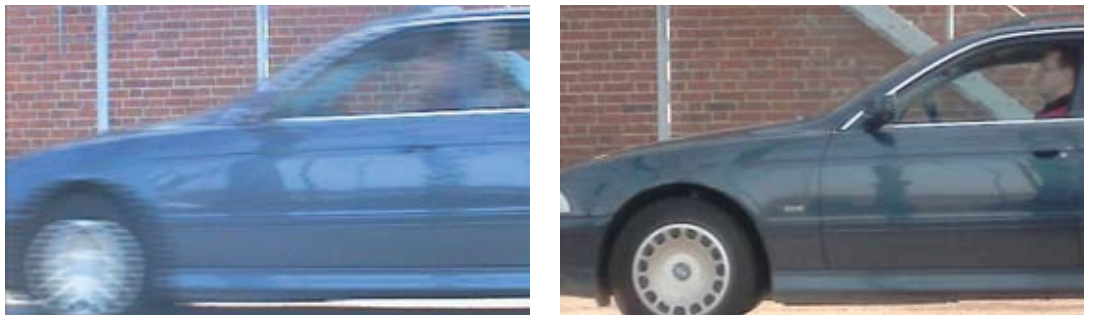
좌측은 인터레이스 스캐닝을 사용하여 아날로그 카메라로 찍은 최대 크기 JPEG 이미지(704x576 픽셀)입니다. 우측은 프로그레시브 스캐닝을 사용하여 엑시스 네트워크 카메라로 찍은 최대 크기 JPEG 이미지(640x480 픽셀)입니다. 양 카메라 모두 동일한 형식의 렌즈를 사용하였으며, 차량 속도도 20km/h(15mph)로 동일했습니다. 두 이미지 모두 배경이 선명합니다. 그러나 프로그레시브 스캐닝을 사용한 이미지에서만 운전자가 선명하게 보입니다.
